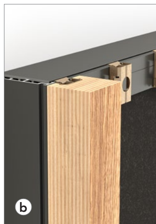
Wcisnąć każdą listwę we wcześniej zamontowane klipsy na profilach poziomych używając miękkiego pobijaka.
